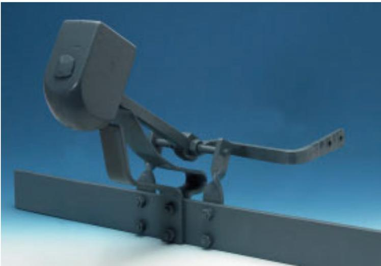
Für die exakte Ausführung von Einzelschlägen auf Uhrschlagglocken oder ruhende Läuteglocken sorgt dieses Präzisionsgerät. Ein robuster, durchzugsstarker Motor treibt eine stabile, langlebige Mechanik an, die den Fallhammer mit einer definierten Aufschlagstärke auf den Schlagring der Glocke treffen lässt.
