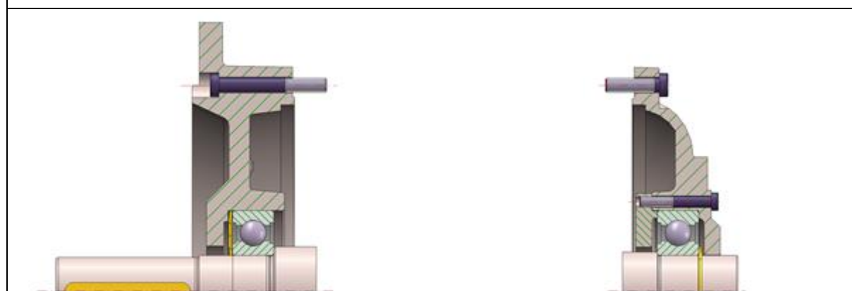
Abbildung 2: Konstruktive Ausführung der Lagerung Bg. 132 – 180 (Festlager Nichtantriebsseite)
