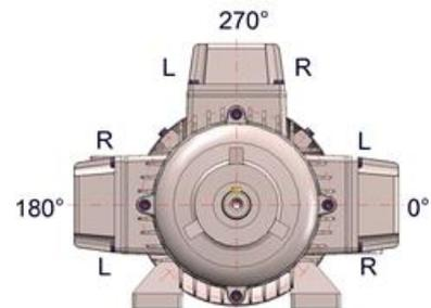
Im Standardfall sind (falls vorhanden) der Bremslüftungshebel und der Klemmenkasten des Fremdlüfters in einer Flucht mit dem Klemmenkasten des Motors ausgeführt. Abweichendes ist gesondert zu bestellen.
