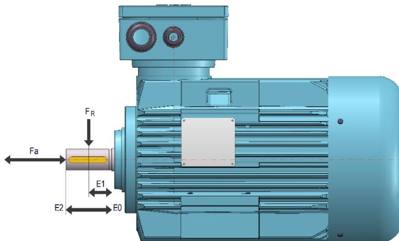
Die Nennlast der Lager ist für eine Lebensdauer von mindestens 20 000 Stunden bei einer Frequenz von 50 Hz berechnet. Es sind nur Axiallasten berücksichtigt worden. Bei kombinierter Axial- und Radialbelastung ergibt sich eine kürzere Lebensdauer der Lager.
