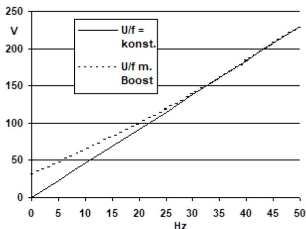
Das Bild zeigt den prinzipiellen Verlauf der  $U/f$  - Kennlinien ohne Boost und mit aktiviertem Boost. Die konkreten Möglichkeiten der Boosteinstellung richten sich nach dem Umrichterfabrikat. Das maximale Moment des Reluktanzmotors ist proportional zum Quadrat der Spannung. Da das Verhältnis von Außertrittfallmoment zu Nennmoment bei ungefähr 1,6 liegt, ist ein Betrieb im Feldschwächbereich ( $U = \text{konstant}$ ) nicht sinnvoll bzw. nur begrenzt möglich.
